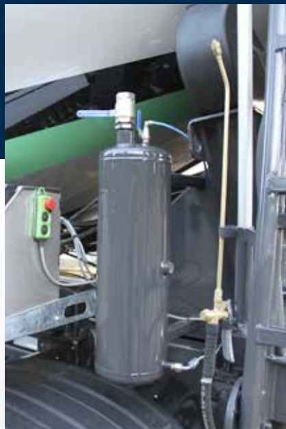
Formoljetank med spiralslang och duschmunstycke. (standard).
