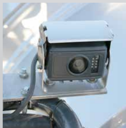
Backkamera på plattform, för lastning av betong (tillval).
