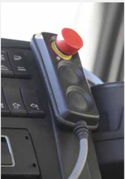
Med manöverdon i hytten hanterar man enkelt och effektivt tömning, blandning, varvtalsreglering och felsökning (standard).
