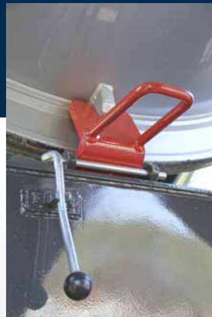
Vid rengöring och underhåll av trumman finns en lättåtkomlig säkerhetslåsning - 3 klackar på trumman (standard).
