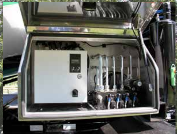
Integrerat styrsåkåp med mottagare till radiostyrning.
